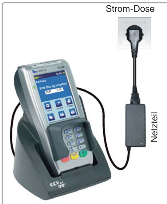
Terminal auf Basisstation
