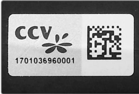
Ein beschädigtes Siegel weist wabenförmige Muster anstelle eines gleichmäßigen Grautons auf, hat Risse oder Schnitte.
